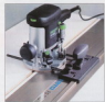
Направляющую линию устанавливаем, если параллельного упора недостаточно для стабилизации станины на небольшом расстоянии от края обрабатываемой детали.
