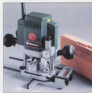
При твердой древесине и глубоких пазах обрабатываем с револьверным упором за три прохода, уменьшая нагрузку на фрезу и двигатель.
