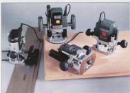
Электрофрезы высокого класса оснащены керамической вилкой и имеют регулировку числа оборотов (для различных материалов).
